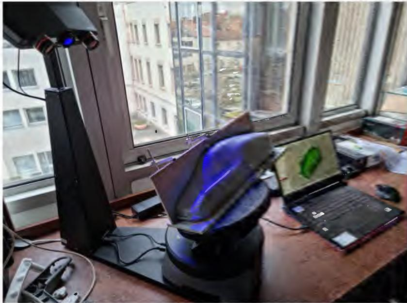
SCAN 3D d'une demi maquette au FABLAB ROANNAIS AGGLOMÉRATION pour travail sur image numérique et impression 3D de la maquette complète à l'échelle 1:8 pour les tests en soufflerie après finition de la forme, en carrosserie.
