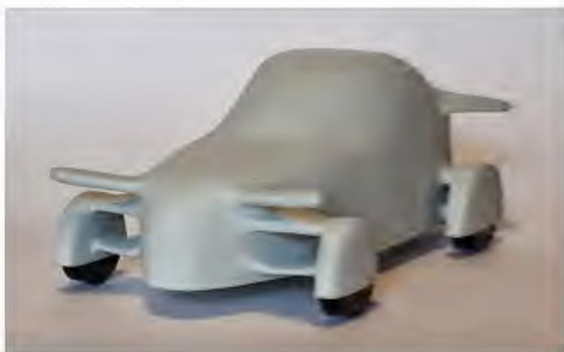
**Version 3 places** : Grâce à l'imbrication partielle des structures de sièges des passagers arrière sous le cockpit du conducteur, la largeur totale de la coque est équivalente à celle d'une berline traditionnelle moyenne. Et la position avancée du cockpit conducteur permet d'avoir une enveloppe extérieure très fidèle au profil Martin Pêcheur pour une meilleure aérodynamique.
